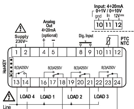
Probe: Pt100=11 - 10 (12); Thermocouple J, K, S= 11(+)- 10(-)
