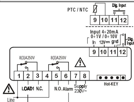
Probe: Pt100=9-11 (10); Thermocouple J, K, S = 9(+); 11(-)
