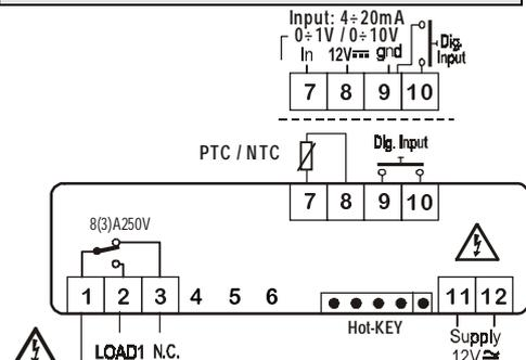
Probe: Pt100= 7 - 9 (8); Thermocouple J, K, S = 7(+); 9(-)
