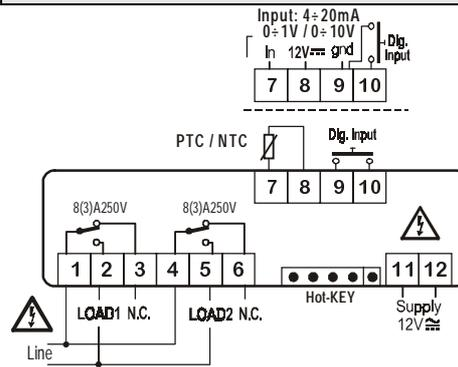
Probe: Pt100= 7 - 9 (8); Thermocouple J, K, S = 7(+); 9(-)
